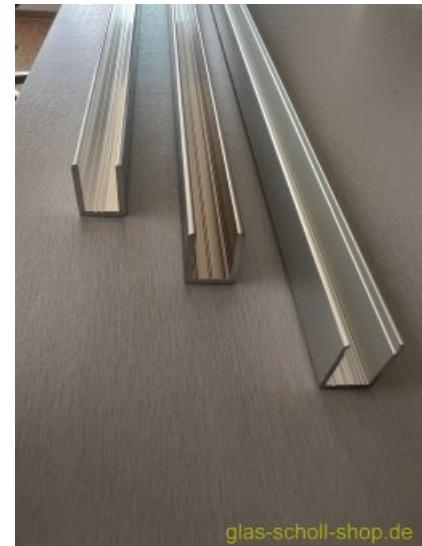
U-Profil zur Befestigung von Festverglasungen im Duschen oder Ganzglasbereich am Boden oder Wand. Die Scheibe muß später bauseitig verklotzt und mit Silikon eingeklebt bzw. versiegelt werden.
