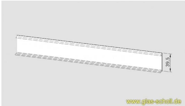
beidseitiges Deckprofil für Wandanschlußprofil/Klemmprofil **D-05.05**
