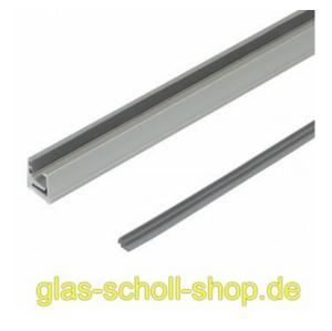
Die Rahmenlösungen MR 22 bestehen aus einem Rahmenprofil (rastergebohrt), einem Spannprofil und zwei Anschlaggummiprofilen (PVC, transparent). Die Rahmen eignen sich sowohl für den Innen- als auch für den Außenbereich und zeichnen sich durch eine sehr einfach Montage aus. Die Ansichtsbreite beträgt beim MR 22 nur 22 mm. Es können Glasstärken von 8 und 10 mm eingesetzt werden.
