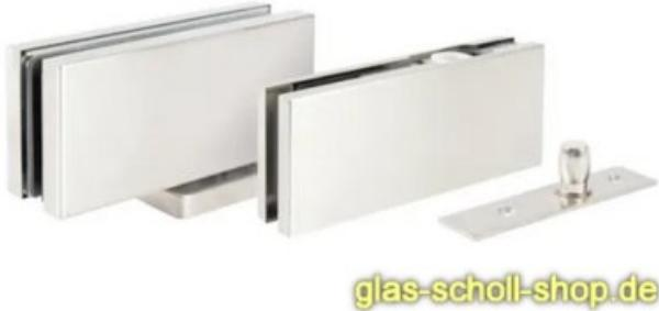
**Der selbstschließende Eckbeschlag Alva ermöglicht eine schnelle Montage ohne aufwändige Bodenausnehmung. Die gesamte Hydraulik für die Selbstschließfunktion ist im schlanken Beschlag selbst untergebracht. Mittels einer Bodenplatte wird der Beschlag mit nur zwei Schrauben am Untergrund befestigt.**
