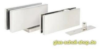
Der selbstschließende Eckbeschlag Alva ermöglicht eine schnelle Montage ohne aufwändige Bodenausnehmung. Die gesamte Hydraulik für die Selbstschließfunktion ist im schlanken Beschlag selbst untergebracht. Mittels einer Bodenplatte wird der Beschlag mit nur zwei Schrauben am Untergrund befestigt.
