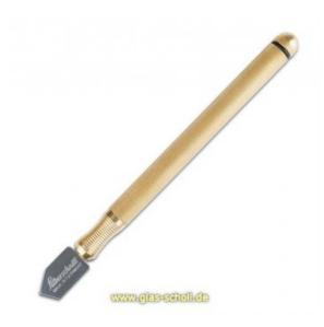
Der Silberschnitt® Öl-Glasschneider für den Zuschnitt beschichteter Gläser. Der "Active"-Schliff verhindert das Zusetzen des Schneidrädchens durch den Abrieb der Beschichtung
