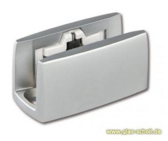
Bei dieser Spezial-Bodenführung wird der Glasschiebeflügel auf der satinierten Seite über eine spezielle, ummantelte Laufrolle geleitet. Die bislang bei der Führung von satiniertem Glas auftretenden, unangenehmen und lauten Laufgeräuschen werden durch diese Neuentwicklung vermieden. Die Rolle hinterläßt auf der Türe bei satiniertem Glas keine Schleifspuren. Die Schiebeflügel laufen nunmehr präzise und deutlich ruhiger.
