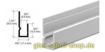
Wird im Allgemeinen an der oberen Kante bei der Spiegelmontage verwendet. Die eingebuchtete Rückseite hält den Spiegel in einem Abstand von der Wand, damit die Ansammlung von Feuchtigkeit und Kondenswasser, die zu Schäden der versilberten Spiegelrückseite führen können, vermieden wird.
