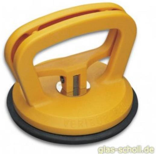
Dank des einhändig zu bedienenden Kipphebelsystems überzeugt er vor allem durch seine einfache und extrem schnelle Handhabung. Entscheidendes Qualitätsmerkmal ist die hochwertige, PAK-freie Gummischeibe in bewährter Bohle Qualität: Sie ist formstabil, aber immer noch weich genug, um sich im Vakuum der Oberfläche anzupassen. Der 1-Kopf-Saugheber hält Lasten bis zu 25 kg (zweifacher Sicherheitsfaktor) und eignet sich für alle Materialien und Objekte mit gasdichten Oberflächen.
