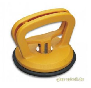
Dank des einhändig zu bedienenden Kipphebelsystems überzeugt er vor allem durch seine einfache und extrem schnelle Handhabung. Entscheidendes Qualitätsmerkmal ist die hochwertige, PAK-freie Gummischeib in bewährter Bohle Qualität: Sie ist formstabil, aber immer noch weich genug, um sich im Vakuum der Oberfläche anzupassen. Der 1-Kopf-Saugheber hält Lasten bis zu 25 kg (zweifacher Sicherheitsfaktor) und eignet sich für alle Materialien und Objekte mit gasdichten Oberflächen.
