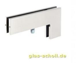
Winkel-Oberlichtbeschlag PT 40 mit einem Bolzen Ø 15 mm verbindet Seitenteil, Oberlicht und Tür in einer Ganzglasanlage. Der Drehpunkt kann auf 55 oder 65 mm eingestellt werden.
