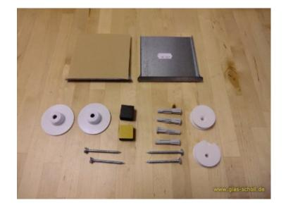
Mit diesem Profi-Montageset können Sie Spiegel unsichtbar und schwebend vor der Wand montieren. Der Spiegel ist oben aufgehangen und wird, damit der nicht von den Haltern fällt, unten mit Druckknöpfen fixiert. Man kann den Spiegel, auf Wunsch, sehr einfach demontieren, indem man die unteren Druckknöpfe löst und den Spiegel abhängt.
