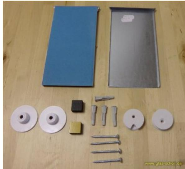
Mit diesem Profi-Montageset können Sie Spiegel unsichtbar und schwebend vor der Wand montieren. Der Spiegel ist oben aufgehängt und wird, damit er nicht von den Haltern fällt, unten mit Druckknöpfen fixiert. Man kann den Spiegel, auf Wunsch, sehr einfach demontieren, indem man die unteren Druckknöpfe löst und den Spiegel abhängt.
