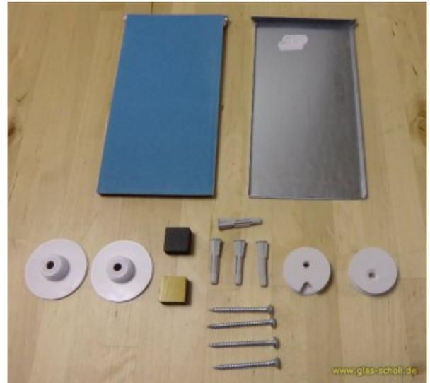
Mit diesem Profi-Montageset können Sie Spiegel unsichtbar und schwebend vor der Wand montieren. Der Spiegel ist oben aufgehängt und wird, damit der nicht von den Haltern fällt, unten mit Druckknöpfen fixiert. Man kann den Spiegel, auf Wunsch, sehr einfach demontieren, indem man die unteren Druckknöpfe löst und den Spiegel abhängt.
