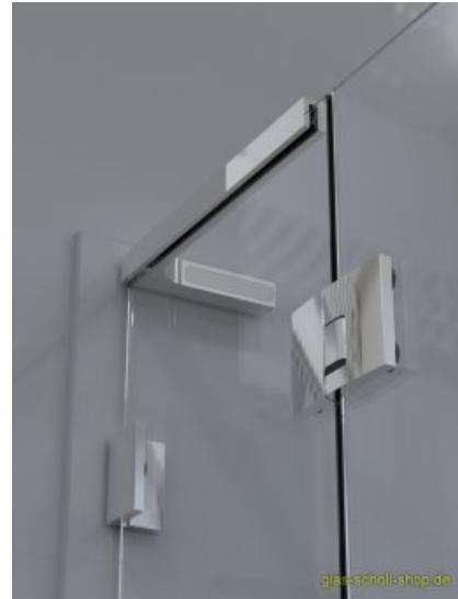
Wenn z.B. 45° Stabistangen nötig sind und dies oft nicht möglich ist oder stört, kommt dieser Stabilisierungswinkel ins Spiel. Durch diesen massiven aufsteckbaren Winkel ist es möglich die Dusche auszusteifen und auf eine Stabistange zu verzichten. Die zu stabilisierende Scheibe muß **mindestens** 300 mm breit sein.
