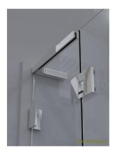
Wenn z.B. 45° Stabistangen nötig sind und dies oft nicht möglich ist oder stört, kommt dieser Stabiliserungswinkel ins Spiel. Durch diesen massiven aufsteckbaren Winkel ist es möglich die Dusche auszusteifen und auf eine Stabistange zu verzichten. Die zu stabiliserende Scheibe muß **mindestens** 300 mm breit sein.
