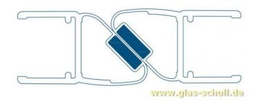
180° versetzte Dichtung für 10-12mm Glasstärke (2500 mm)
