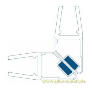
90° Magnet Dichtung für 10-12mm Glasstärke (2500 mm)
