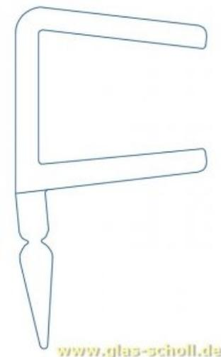
Diese Dichtung wird bei versetzten Schiebetüren verwendet. **(ÜBERLÄNGE)**
