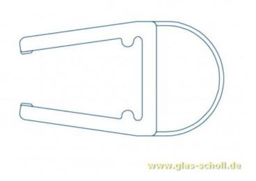
Streifdichtung als seitliche Duschdichtung für 6-8mm Glasstärke Anwendung für Wandanschluss oder auch als Abdichtung bei Pendeltüren 2500mm
