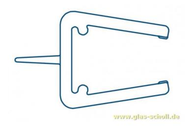
Anwendung für Wandanschluss oder auch als Abdichtung bei Pendeltüren 2010mm
