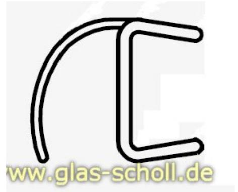
**180° schlanke Spaltdichtung als Mitteldichtprofil oder Wandanschlußprofil für 8mm Glasstärke**
