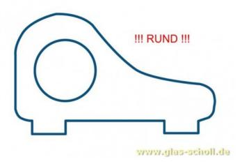
unterer gebogener Schwallschutz weiss (~775 mm) Duschdichtung für 1schalige Türen und Wannen-Radius 500mm (Glasradius 480) RAL9016
