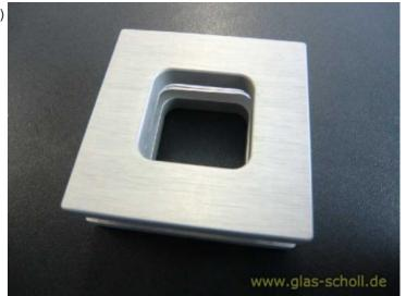
G64 eckig Leichtmetall-Griffmuschel eckig (Paar) **gebürstete Aluoptik - kein Edelstahl** beidseitig 10mm auftragend Außenmaß 64x64mm für zwei Lochbohrung d=10mm (Achsabstand=47mm) Für Glas- bzw. Plattenstärke 8-10 mm
