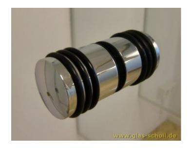
P8298 **beidseitig** aufschraubbarer runder Türgriff - d=30mm Tiefe=33mm (Paar) vorgesehen für 8-12mm Elementdicke und 14mm Lochbohrungen Die Gummiringe können bauseitige auch gerne entfernt werden!
